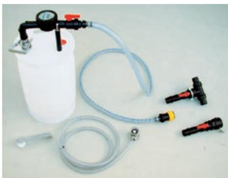
Das System kann an eine freie Saugkupplung des Spritzgerätes oder mittels eines T-Stücks auch direkt an die Saugleitung zwischen Behälter und Pumpe angeschlossen werden. Die Entnahmemenge wird über den Durchflusszähler exakt gemessen und über das eingebaute Kugelventil geregelt.
