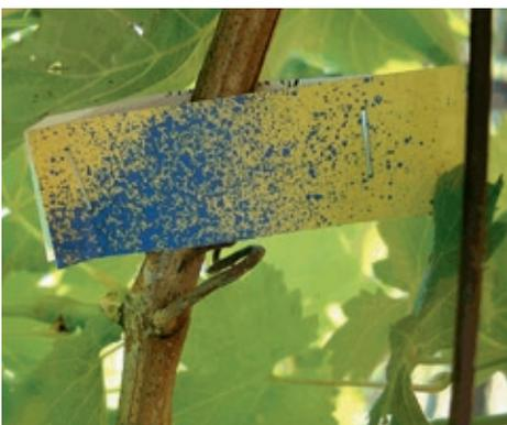
Testpapierstreifen mit Spezialbeschichtung, verfärbt sich blau bei Kontakt mit Wasser, ideal zur Überprüfung von Bestandsdurchdringung, Tropfendichte und Belagsstruktur, werden einfach wie Blätter in den Bestand gehängt
