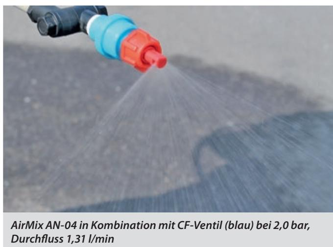
AirMix AN-04 in Kombination mit CF-Ventil (blau) bei 2,0 bar,
